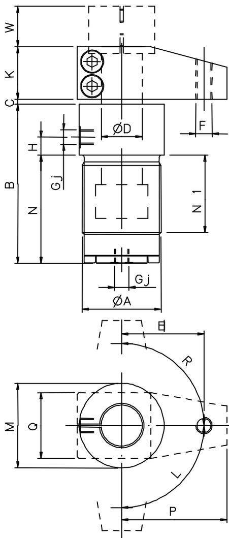
I modelli **BRA** sono dei cilindri idraulici a semplice effetto con azione in tiro e ritorno a molla. Nel primo tratto della corsa di chiusura la staffa effettua, per avvvitamento, anche una rotazione di 90° (±3°), poi prosegue la corsa di bloccaggio senza movimenti angolari.
